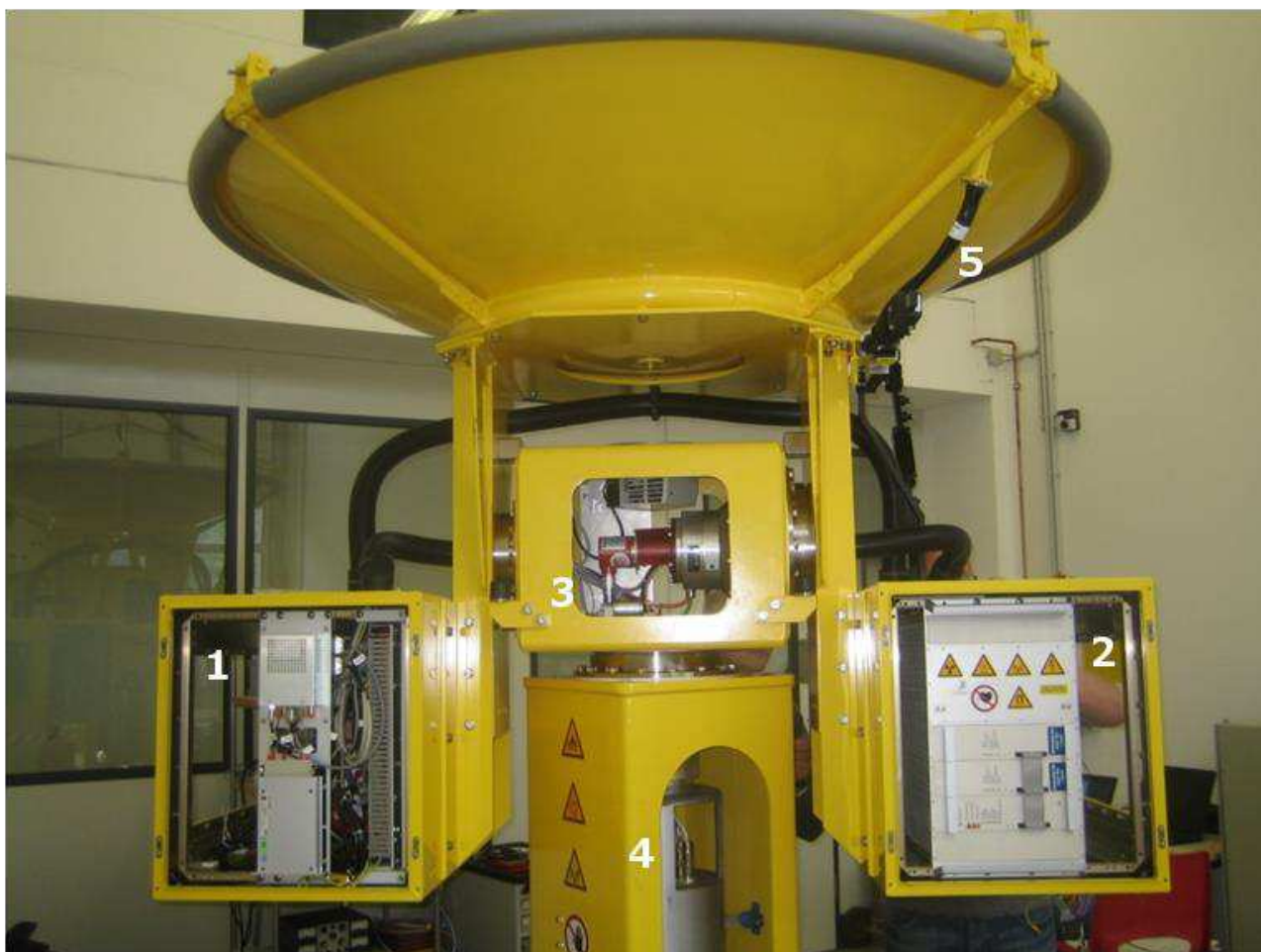
Figure 5. Radar doppler polarimétrique en bande X (modèle Selex Météor 50 DX) installé dans le cadre du projet Rhythme. Le diamètre de l'antenne est de 1,80 m. 1 : processeur de contrôle radar ; 2 : émetteur-récepteur ; 3 : boîtier de contrôle du site ; 4 : boîtier azimutal ; 5 : guide d'onde et antenne. La rotation dans les plans horizontal (4) et vertical (3) permet une exploration volumique de l'atmosphère. L'émetteur (2) génère une impulsion électromagnétique de forte puissance, de l'ordre de 70 kW, qui est transmise à l'antenne via le trajet du guide d'onde (5). Cette impulsion électromagnétique est réfléchiée et retournée vers le radar par les cibles que constituent les hydrométéores présents dans l'atmosphère. L'intensité du signal retourné au radar est fonction de la densité et de la surface de réflectivité ces cibles. L'antenne (5) amplifie le signal reçu avant de le transmettre au récepteur (1 et 2), toujours via le trajet du guide d'onde, qui le convertit en signal électrique analysable par le ordinateur Castor. Photo © Serge Dalle, Météo-France.
