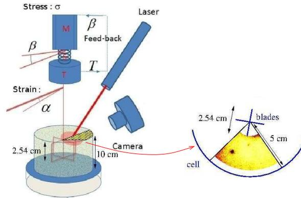
**Figure 1.** Schéma du dispositif expérimental. M : moteur, T : capteur de mesure du couple. Le dispositif optique de détection comprend une lentille et un diaphragme (Fig. 2). Un extrait de carte de corrélation en intensité est montré sur la partie droite de la figure, dans toutes les représentations utilisées, l'échelle de couleur correspond à une corrélation  $g_I = 1$  pour le jaune le plus clair et  $g_I \leq 0.95$  pour le noir.
