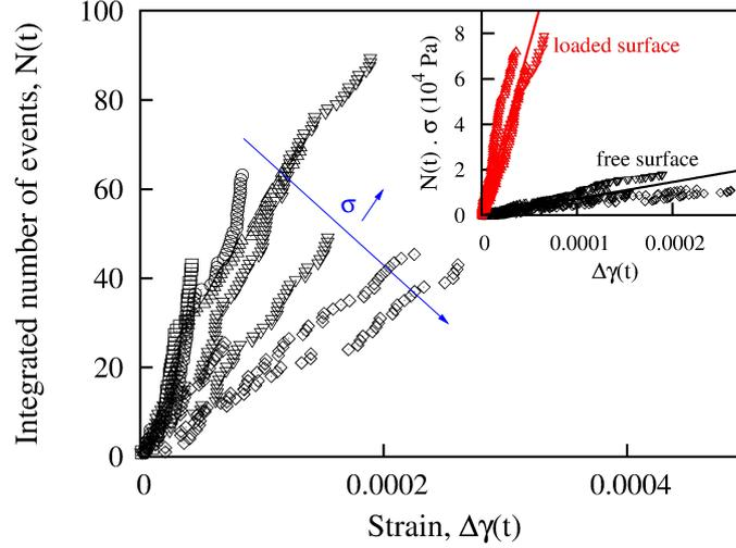
**Figure 5.** Nombre cumulé de zones de déformation localisée en fonction de la déformation globale, mesurée indépendamment, durant une expérience de fluage et pour différentes valeurs de la contrainte imposée  $\sigma$ . Insert : produit  $\sigma N$  en fonction de  $\Delta\gamma$  pour deux valeurs différentes du module de cisaillement  $G$  du matériau.
