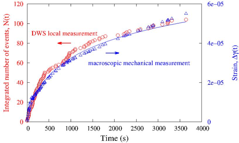
**Figure 4.** En bleu : déformation macroscopique globale mesurée lors d'une expérience à contrainte imposée. La courbe en trait continu bleu est un ajustement par une loi logarithmique correspondant à la résolution des équations 2 et 3. En rouge, intégration du nombre de points observés simultanément sur les cartes de déformation.
