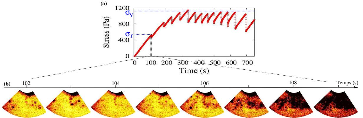
**Figure 3.** Charge du matériau granulaire à rotation du moteur imposée. (a) Réponse en contrainte :  $\sigma_r$  est le premier précurseur à la rupture,  $\sigma_Y$  désigne la contrainte de rupture du matériau au-delà de laquelle la réponse correspond à un régime de *stick-slip*. (b) série de cartes de corrélations successives montrant la déformation locale. L'échelle de couleur est la même que celle de la figure 1.
