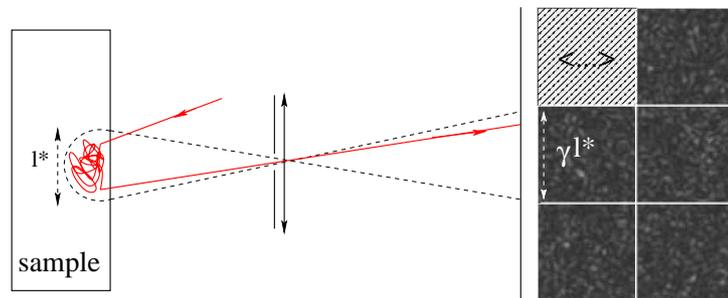
**Figure 2.** Schéma du dispositif de détection optique : une lentille fait l'image de la surface de l'empilement sur la caméra avec un grandissement  $\gamma$  et un diaphragme permet de contrôler la taille des taches de speckle obtenues sur la matrice CCD. A droite : extrait d'une figure de speckle sur laquelle sont représentées les zones utilisées pour les moyennes d'ensemble dans le calcul de corrélation en intensité entre deux images successives.
