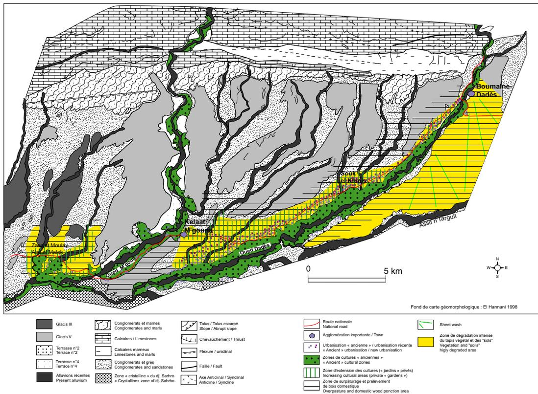
FIGURE 7 Croquis de synthèse des processus de dégradation et de leurs facteurs de la zone est du bassin de l'oued Dadès (Maroc). *Degradation processes and factors synthetical sketchmap of the east part of wadi Dadès basin (Morocco).*
