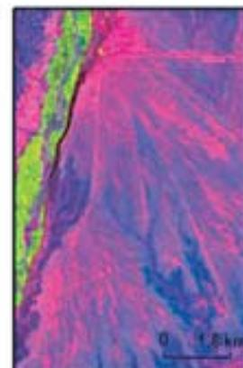
FIGURE 3 Composition colorée combinant trois axes d'une ACP sur les 6 canaux bruts TM de Landsat-5 du 27-08-1987. Axe 1 : bleu ; axe 3 : vert ; axe 2 : rouge. + 3 zooms. *Color composite of three PCA axis using 6 TM Landsat-5 raw channels dated 27-08-1987. Axis 1 : blue; axis 3 : green; axis 2 : red. + 3 zooms.*
