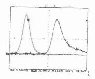
Figure 9 : Impulsion émise et reçue par le télémètre.
