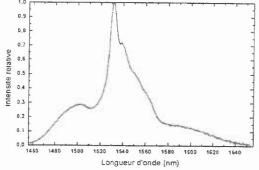
Figure 3 : Spectre d'émission du verre codopé Er et Yb au voisinage de 1,5 µm.
