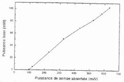
Figure 5 : Puissance laser en fonction de la puissance de pompe absorbée.
