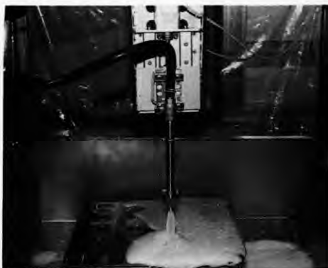
Fig 1. Vue du robot : le canon à mousse (fixé à l'axe vertical) se déplace au-dessus de la plaque comportant les éprouvettes.
