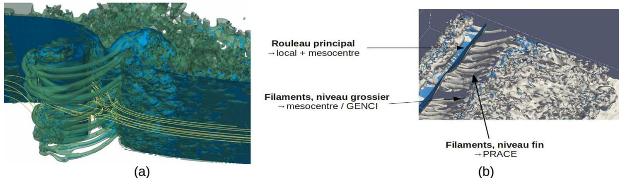
Figure 4 : (a) Structures tourbillonnaires cohérentes sous la vague déferlante. L'enveloppe des vortex est visualisée par l'isovaleur  $Q = 1$  (en vert) ; la surface libre est identifiée par l'isovaleur de la fonction de phase (en bleu), indiquant l'entraînement de l'air ; les lignes de courant indiquent le mouvement de spirale autour d'un filament de vortex aéré. (b) Mise en évidence de l'intérêt du calcul intensif et de l'architecture pyramidale des moyens matériels.
