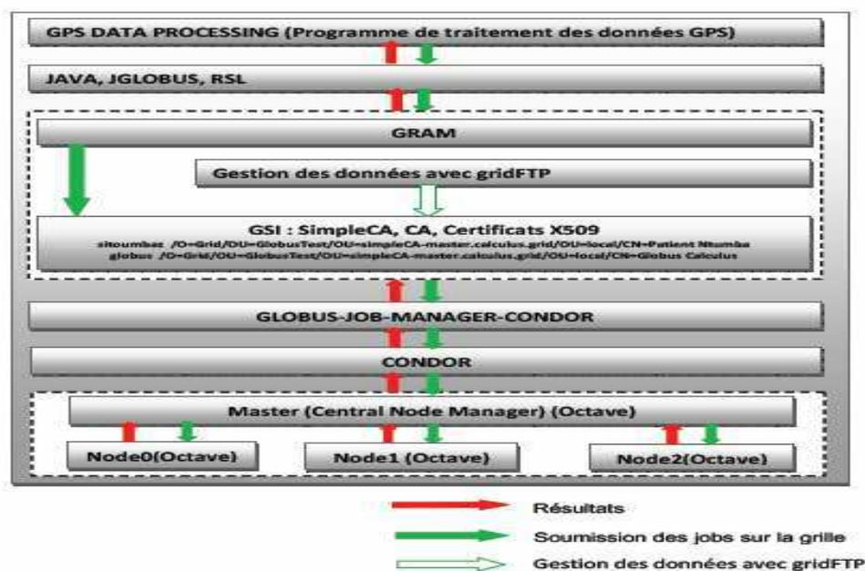
Figure 1 : Architecture de la grille de calcul
