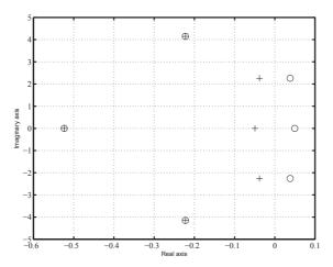
Figure 16: Circle: eigenvalues of the plant; (*o*): eigenvalues of  $\tilde{A}$ ; (+): eigenvalues of  $\tilde{A} - \tilde{B}K_c$ .
