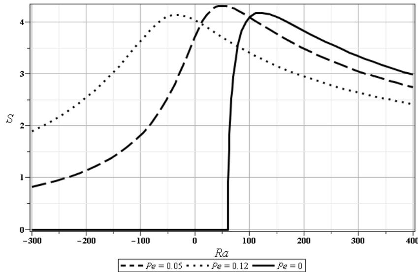
FIG-4. Séparation en fonction du nombre de Rayleigh pour  $Pe = 0$ ,  $Pe = 0.05$ ,  $Pe = 0.12$  avec  $Le = 120, \psi = 0.1$ .
