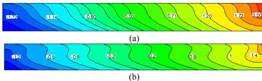
FIG.3- Iso-concentrations et variation du champ de concentration en fonction du nombre de Péclet ( $Pe$ ) (a)  $Pe = 0.08$ , (b)  $Pe = 0.16$ , avec  $Ra = -20$ , et  $Le = 200, \psi = 0.1, A = 10, Pr = 10$
