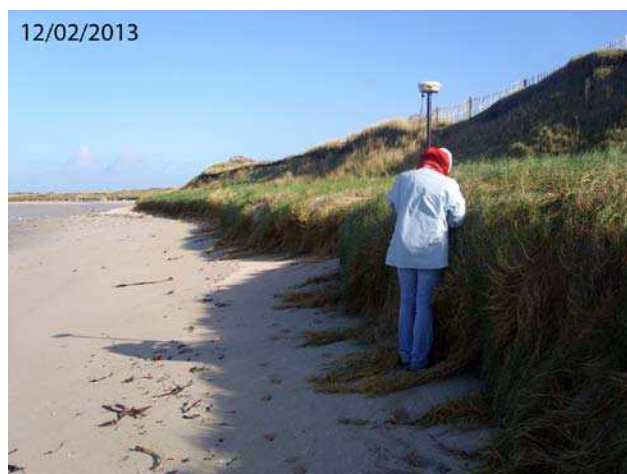
Photo 2. Falaise d'érosion et recul de la dune à l'arrière de l'enrochement de la plage du Curnic (Vougot) – 12/02/2013
