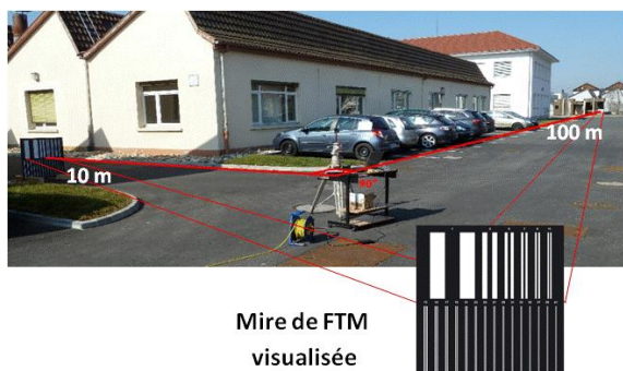
Fig. 11 : montage de test de prises de vues à l'ISL
