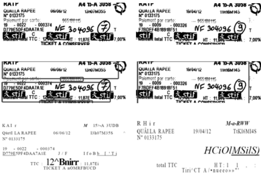
Figure 2. Résultat d'un algorithme de reconnaissance de caractères illustrant les difficultés rencontrées par ce type de logiciel à segmenter puis reconnaître le texte sur des documents de type "notes de frais"
