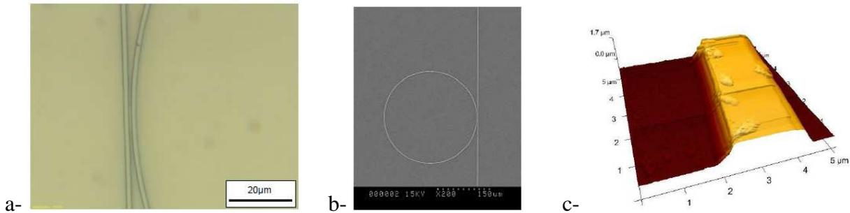
Figure 6 : Images obtenues lors de la création d'un microrésonateur par : -a : microscopie optique ; - b : au MEB ; -c : analyse du guide droit par AFM.
