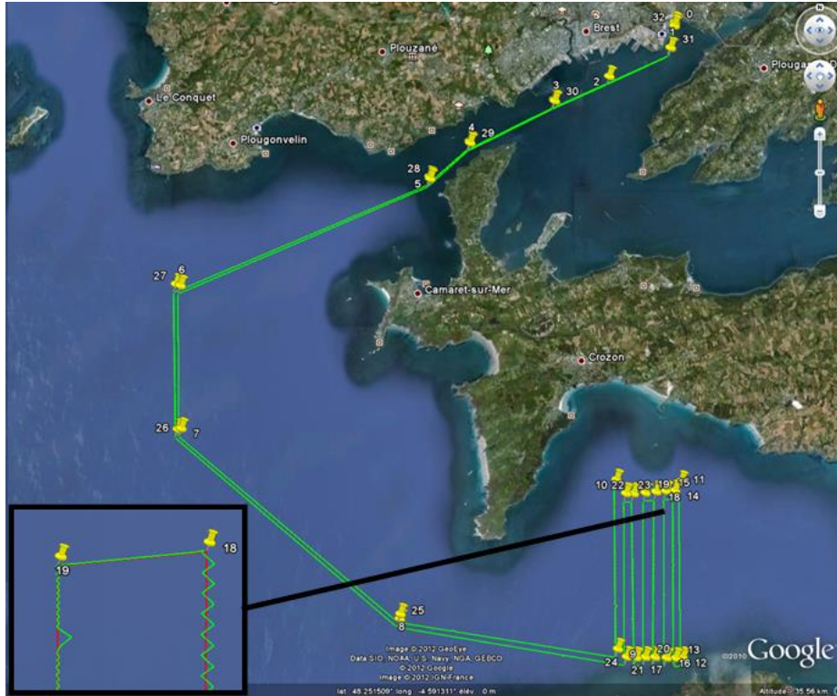
Figure 5 : Simulation de VAIMOS allant de Brest à Douarnenez. La trajectoire désirée (ligne rouges formées par les waypoints jaunes) et la trajectoire (simulée) effective (en vert) semblent superposées. Cependant, en zoomant, on s'aperçoit qu'il y a bien des phases de remontée au vent avec changements de bords. On peut aussi distinguer les étapes de recalibration du moteur de voile (toutes les 2 h), où le voilier dérive pendant une minute
