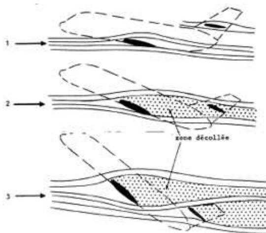
FIGURE 1 – Schéma d'entrée d'un aéronef en décrochage profond [1].
