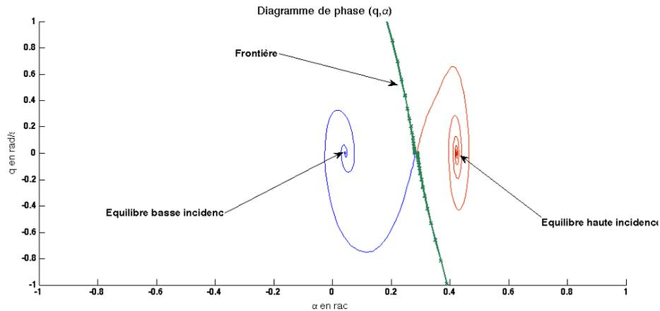
FIGURE 2 – Portrait de phase  $(q, \alpha)$  d'un avion modèle longitudinal.
