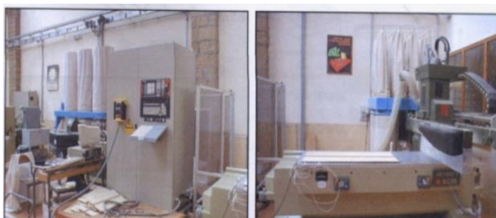
Fig.2. Défonceuse à commande numérique à trois axes.
