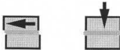
(fig. 8) Contraintes de cisaillement et de compression sur une éprouvette
