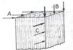
Figure n° 2 Direction de coupe par rapport aux fibres
