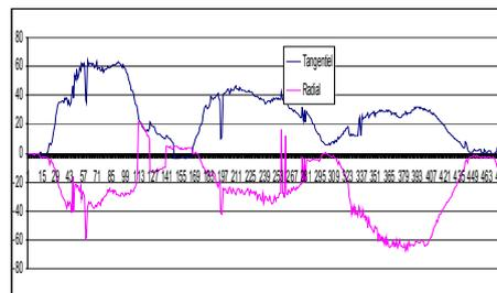
Figure 7 Evolution de efforts de coupe en fonction de l'angle du fil pour une distance de défonçage de 180m
