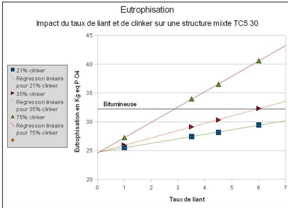
**Figure 50. Indicateur d'eutrophisation pour la structure semi-rigide à différents taux de clinker (structure bitumineuse : 32,2 kg eq. PO<sub>4</sub>)**
