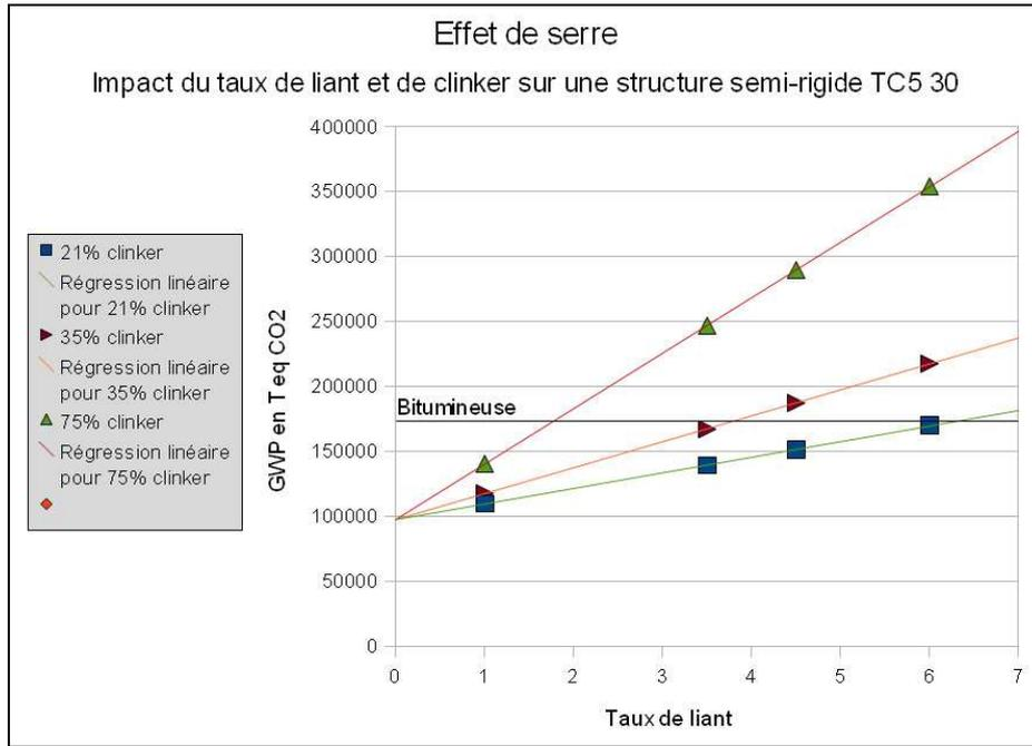
**Figure 48. Indicateur d'effet de serre pour la structure semi-rigide à différents taux de clinker (structure bitumineuse : 171 761 kg eq. CO<sub>2</sub>)**
