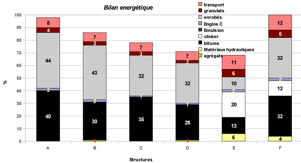
**Figure 30. Bilan énergétique sur structure globale avec couche d'assise
