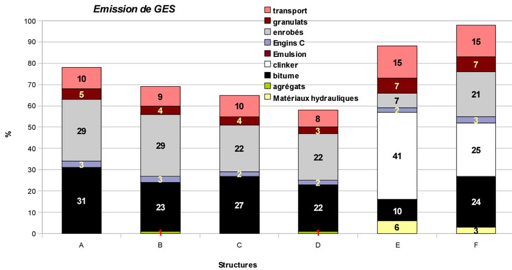
**Figure 32. Emissions de gaz à effet de serre sur structure globale avec couche d'assise
