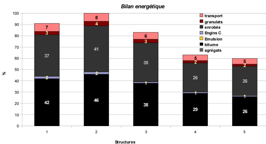
Figure 21. Bilan énergétique par couche de roulement
