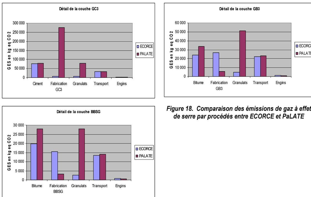
Figure 18. Comparaison des émissions de gaz à effet de serre par procédés entre ECORCE et PaLATE
