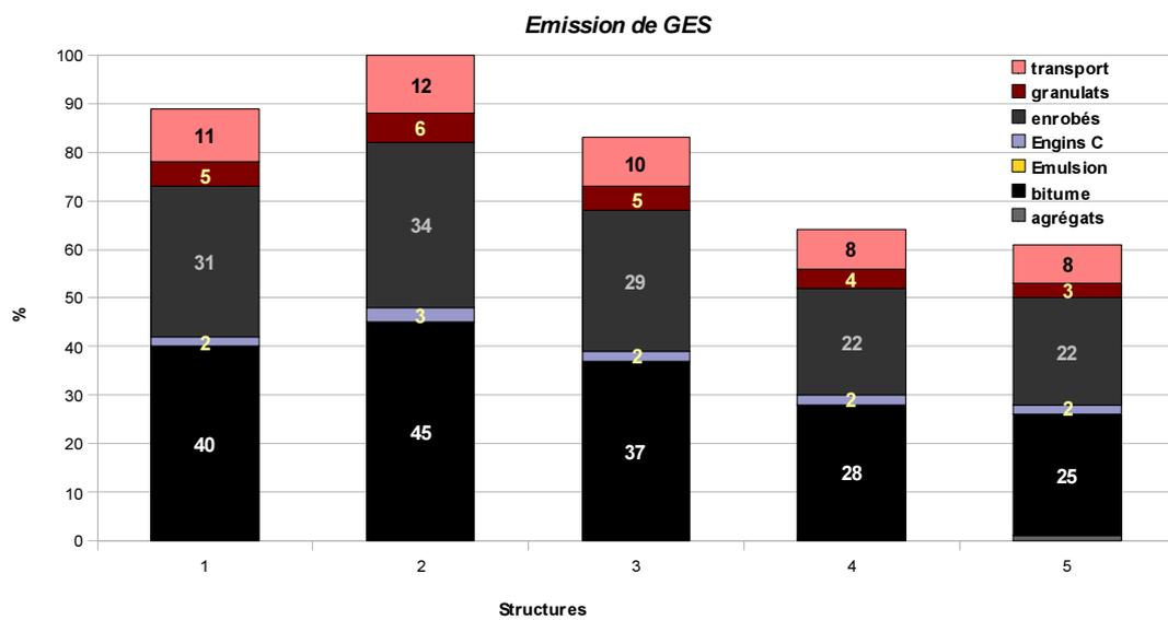
**Figure 23. Emissions de gaz à effet de serre par couche de roulement**
