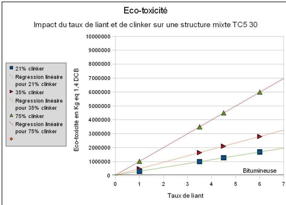
**Figure 44. Indicateur d'écotoxicité pour la structure mixte à différents taux de clinker (structure bitumineuse : 24 671 kg éq. 1,4DCB)**
