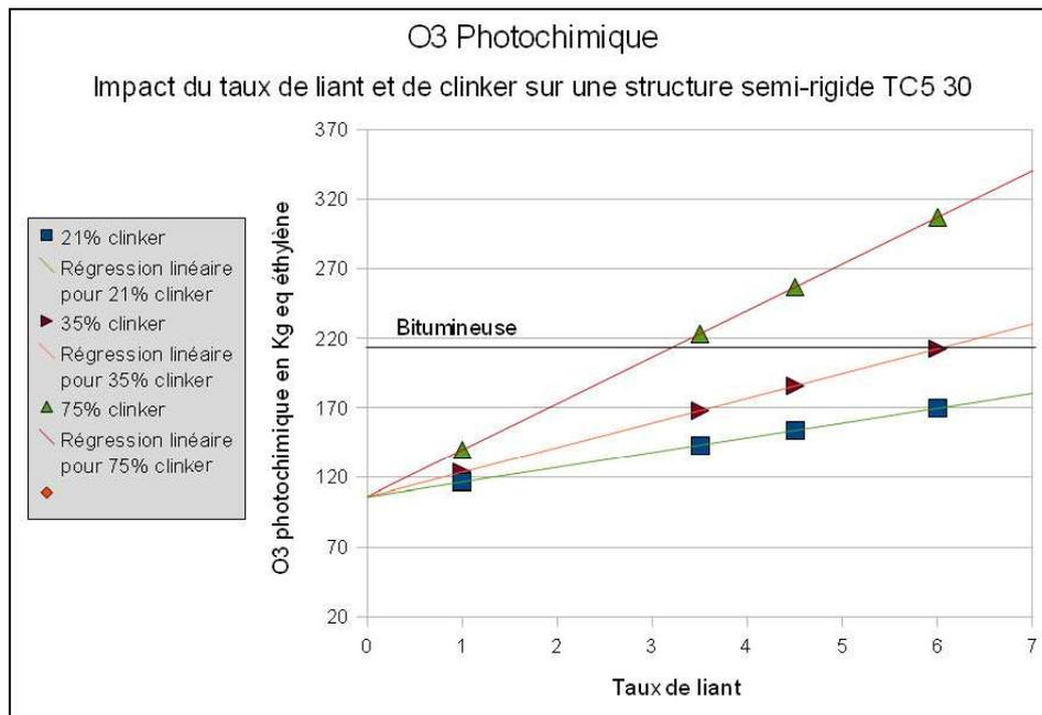
**Figure 51. Indicateur d'ozone photochimique pour la structure semi-rigide à différents taux de clinker (structure bitumineuse : 214 kg eq. éthylène)**
