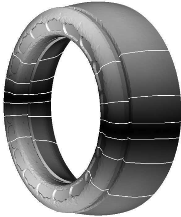
a: First orthoradial mode - f = 344 Hz
