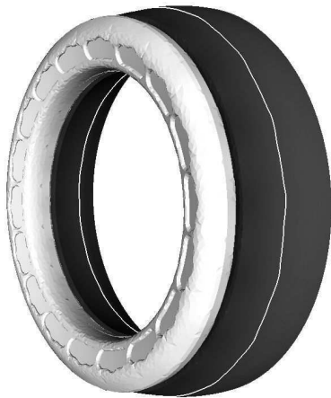
c: First longitudinal mode - f = 846 Hz
