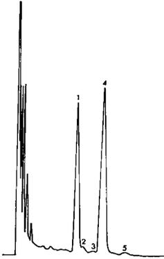
FIG. 1. — Chromatogramme de glucides dissous dans le diméthylformamide
