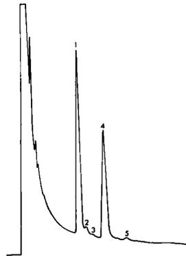
FIG. 4. — Chromatogramme de glucides, en milieu aqueux, silylés avec addition d'acide trifluoroacétique
