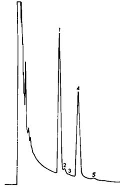
FIG. 2. — Chromatogramme de glucides dissous dans la pyridine
