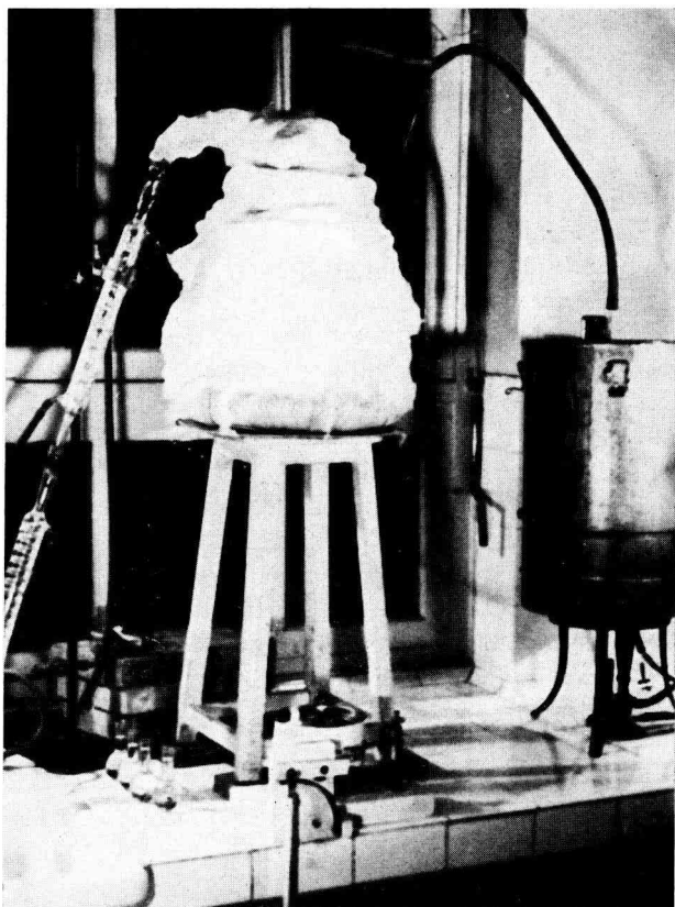
FIG. 1 — Alambic utilisé au Laboratoire pour l'extraction des essences à la vapeur d'eau
