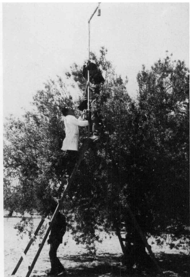
Figure 3 Mesure des réflectances sur olivier. On notera le mât-support, les têtes de mesure, et la bonne verticalité de l'ensemble. Reflectivity measurements over an olive tree. Note the mast, the measuring heads and the good vertical alignment.
