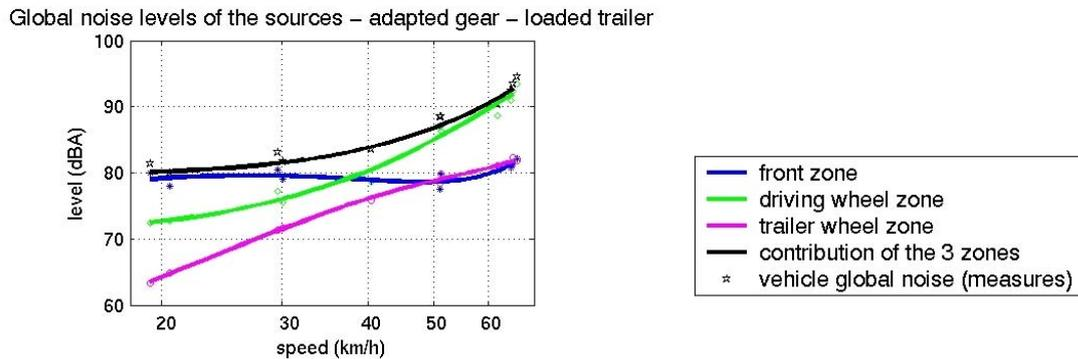
**Figure 4. Tracteur + remorque en conditions contrôlées : évolution du niveau de bruit des 3 zones sources avec la vitesse (en km/h) (configuration remorque chargée, rapport adapté)**
