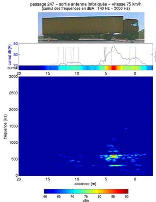
Figure 5. Cartographie au passage d'un poids lourd à 75 km/h
