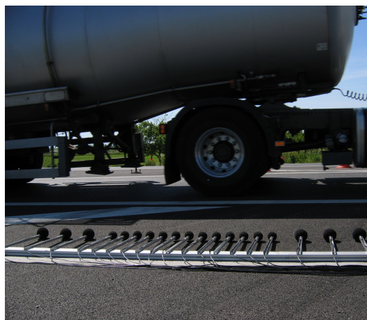
Figure 2. Antenne microphonique horizontale pour la caractérisation des sources des PL au passage
