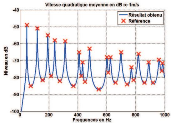
FIG. 5: Vitesse vibratoire quadratique moyenne d'une plaque carrée de 1m de côté soumise à une force ponctuelle de 1N appliquée en  $(0, 7; 0, 2)$ . Les résultats de référence sont représentés par des croix rouges [4].
