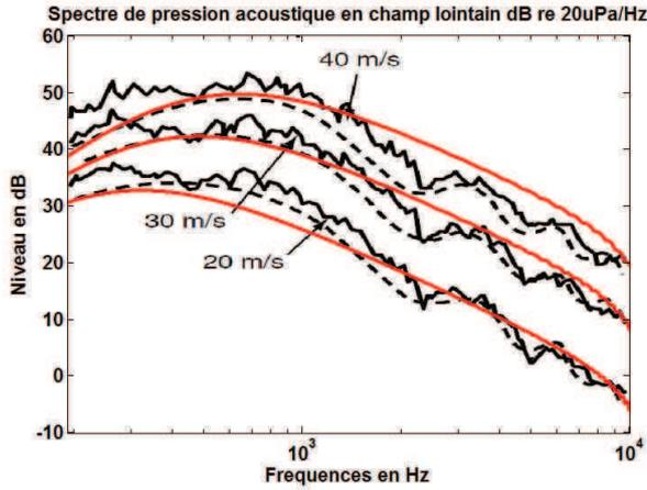
FIG. 3: Autospectres de pression acoustique prédits par l'équation 5 (en rouge), prédits par le modèle d'Amiet (en tirets) et mesurés [5] (en traits noirs continus)
