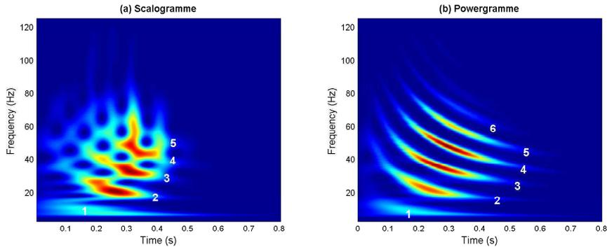
FIGURE 2 – Résultats expérimentaux sur les données Mer du Nord. (a) Scalogramme du signal reçu, (b)  $\beta$ -powergramme du signal reçu. Le powergramme a été calculé avec la valeur  $\beta = 1$ . Les chiffres blancs donnent les numéros des modes.
