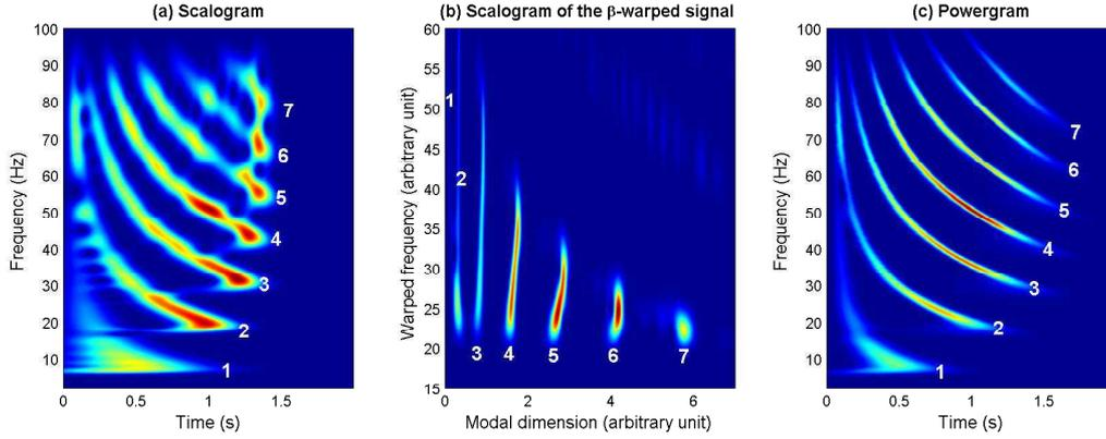
FIGURE 1 – Données simulées. (a) Scalogramme du signal reçu. (b) Scalogramme de la transformée de Fourier inverse du signal  $\beta$ -warpé. (c)  $\beta$ -powergramme. Le  $\beta$ -warping et le powergramme ont été calculés avec  $\beta = 1.2$ . Les chiffres blancs donnent les numéros des modes.
