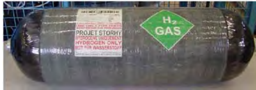
Figure 2 : Réservoir de stockage d'hydrogène à 70 MPa développé par le CEA dans le cadre du projet Européen STORHY. Le volume d'hydrogène stocké à 70 MPa et 15 °C est de 37 litres, correspondant à une masse de 1,5 kg d'hydrogène [2].
