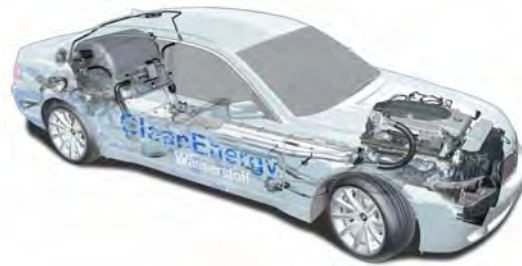
Figure 6 : Véhicule développé par BMW (« Hydrogen 7 series ») équipé d'un système de stockage d'hydrogène liquide disposé dans le coffre [6].
