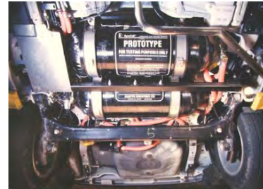
Figure 9 : Intégration de 2 réservoirs de stockage utilisant les hydrures métalliques développés par la société Ovonix disposés dans le châssis d'une TOYOTA Prius [11].
