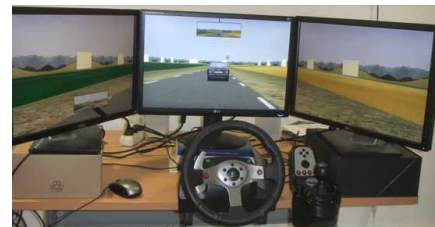
FIGURE 2 – Dispositif du simulateur de conduite avec 3 écrans, volant, boîte de vitesse et pédalier.
