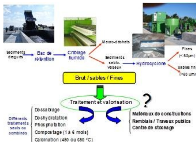
Figure 1. Synoptique de prise en charge des sédiments sur la plate-forme de Brégaillon
