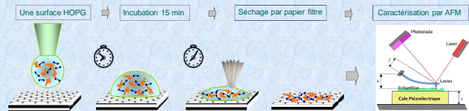
Figure (1) Représentation schématique de la méthode de déposition utilisée
