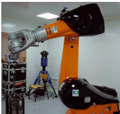
Fig. 2. Identification des raideurs apparentes du robot.
