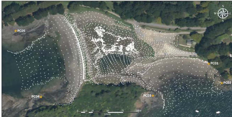
Figure 27 – Répartition des points de mesures DGPS et localisation des points de calage.
