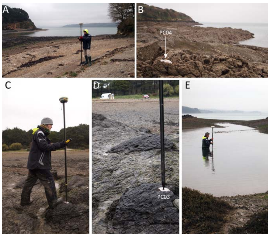
Figure 2 – Photographies illustrant les repères topographiques installés et l'instrumentation utilisée dans le cadre des relevés topographiques. A. Relevé effectué au DGPS mobile (Trimble 5700). B. Point de calage PC04 scellé sur une tête de roche sur le site du Bindy. C et D. Relevé d'un point de calage. E. Relevé de la topographie du fond de l'étang du Bindy.
