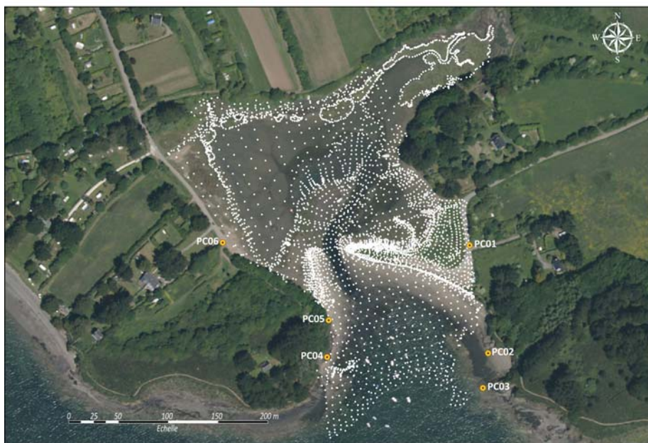
Figure 31 – Répartition des points de mesures DGPS et localisation des points de calage
