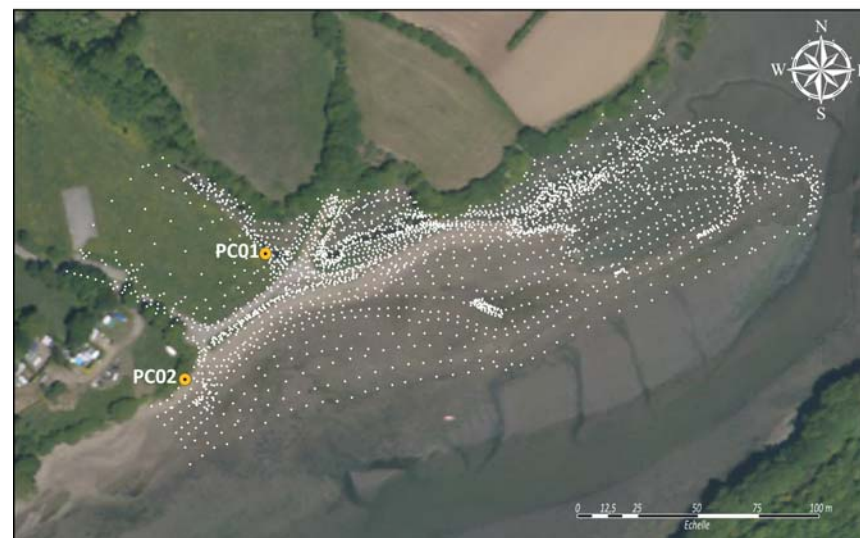
Figure 4 – Répartition des points de mesures DGPS et localisation des points de calage.
