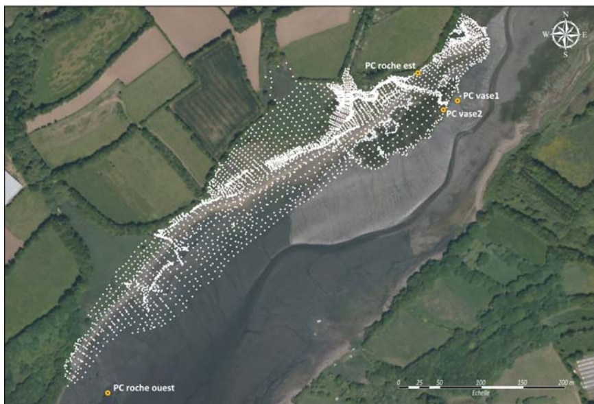
Figure 11 : Répartition des points de mesures DGPS et localisation des points de calage.
