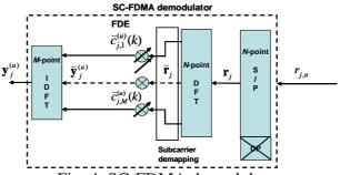
Fig. 4. SC-FDMA demodulator
