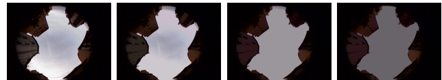
Fig. 4. Reconstruction géodésique en fonction du paramètre de contraste H (de gauche à droite : image originale, RGD avec H = 50 , avec H = 100 et avec H = 150 ).
