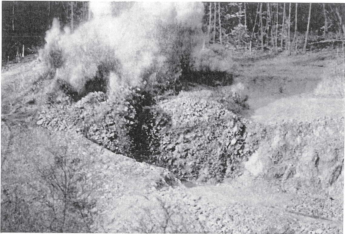
Figures 22-23 – tirs surchargés provoquant une émission à grande vitesse de projections et de gaz.
