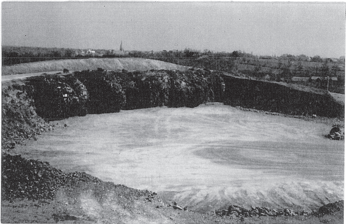
Figure 8 – Exemple de gonflement initial du massif sur un tir de carrière (surface du (front 1000 m 2 ))
