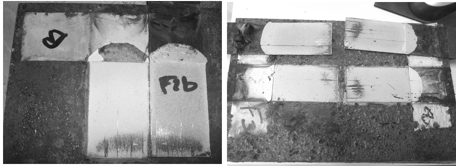
Figure 6. Photos des modes de rupture après 8 mois puis 22 mois de vieillissement
