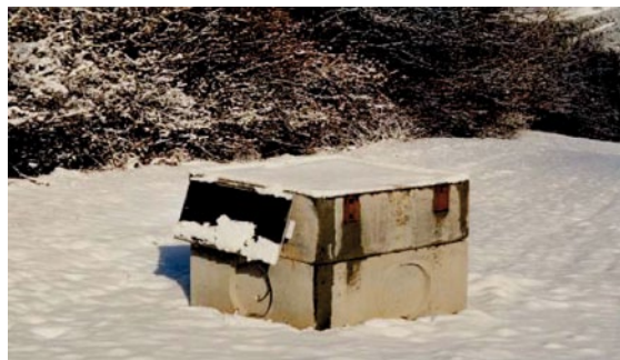
figure 6 Exemple de dispositif de protection d'un enregistreur sismique en région alpine
