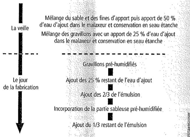
Figure 2 Exemple du protocole de préparation et de fabrication d'une grave-émulsion
