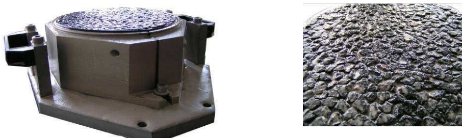
Fig.9 – Dépôt de silice après la phase de polissage
