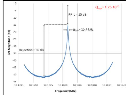
Figure 2 : Mesure par analyse fréquentielle d'une boucle fibrée de 120 m,  $Q = 1.25 \cdot 10^{10}$  (LAAS)
