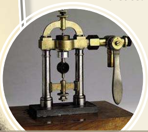
Le miroir tournant, pièce centrale du dispositif expérimental de Foucault.
