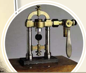
Le miroir tournant, pièce centrale du dispositif expérimental de Foucault.
