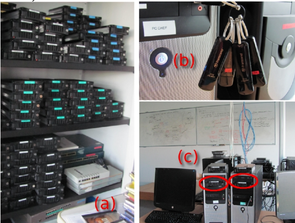
Fig 9: (a) Jeux de disques durs : 1 jeu par module (b) Jeu de clefs USB (c) PC étudiants avec rack pour interchanger les disques durs
