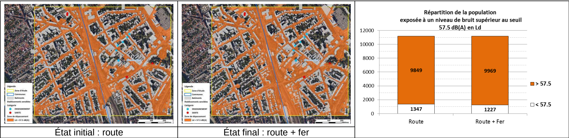
Figure 20 : Cartographie des zones de dépassement de la valeur seuil L_d = 57,5 dBA et population potentiellement exposée au-dessus de la valeur seuil dans les deux configurations avant / après.
