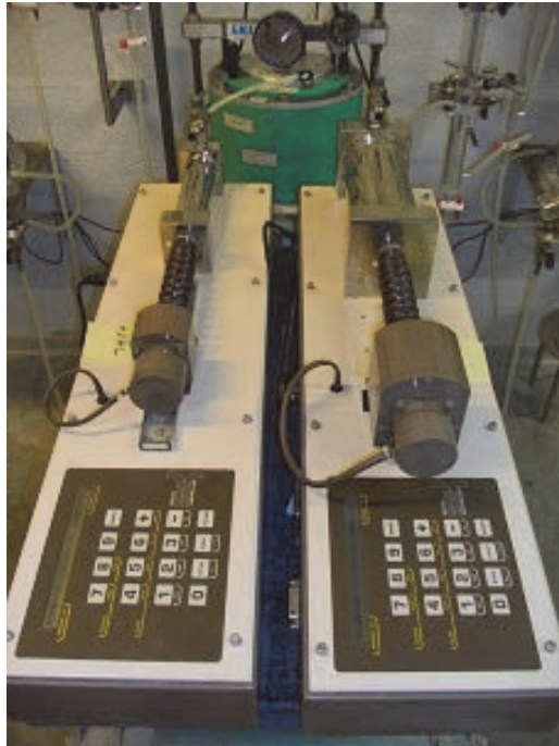
Figure 4. Dispositif expérimental permettant la mesure du flux au travers des géofilms bentonitiques.
