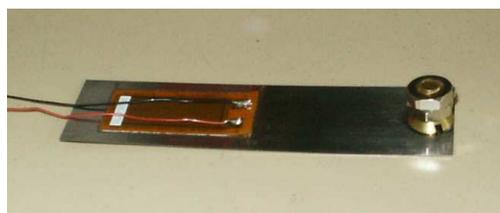
Figure 13 : Photo du transducteur poutre MFC
