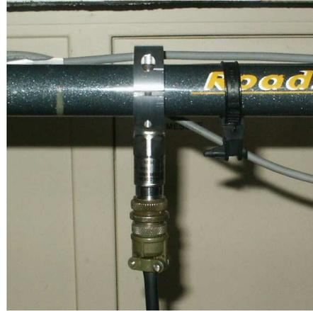
Figure 4 : Fixation verticale d'un accéléromètre sur le cadre
