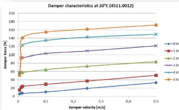
Figure 6 : Evolution de l'amortissement, en fonction de la tension imposée et de la vitesse de déplacement de l'amortisseur.
