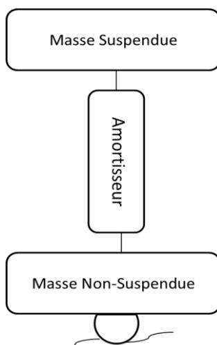
Figure 5 : Schéma de principe d'un quart de véhicule.
