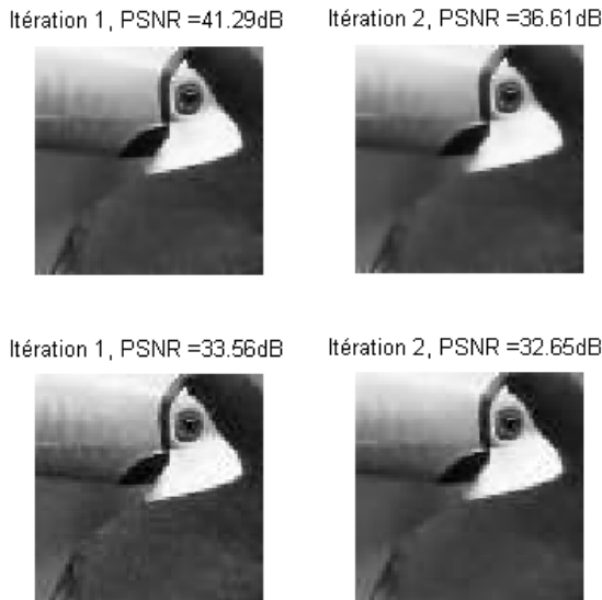
Figure 12: Expérience de débruitage avec la méthode à cinq points (haut) et neuf points (bas).
