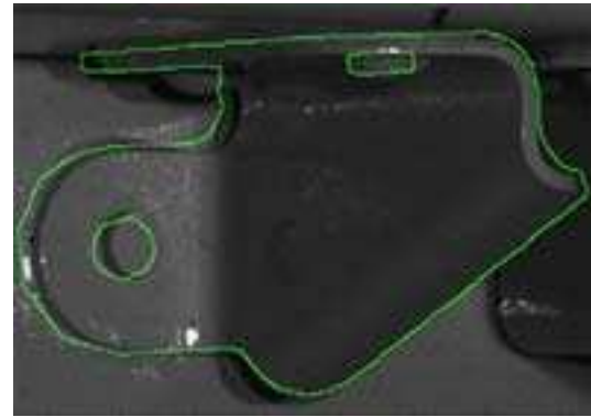
FIGURE 12 – Position finale d'un élément réel par rapport à un élément de référence.
